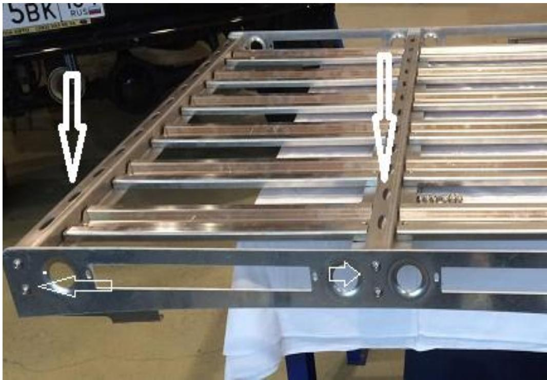
При этом при установки задней перекладины багажника надо установить, между ними задние кронштейны крепления багажника на крыше
