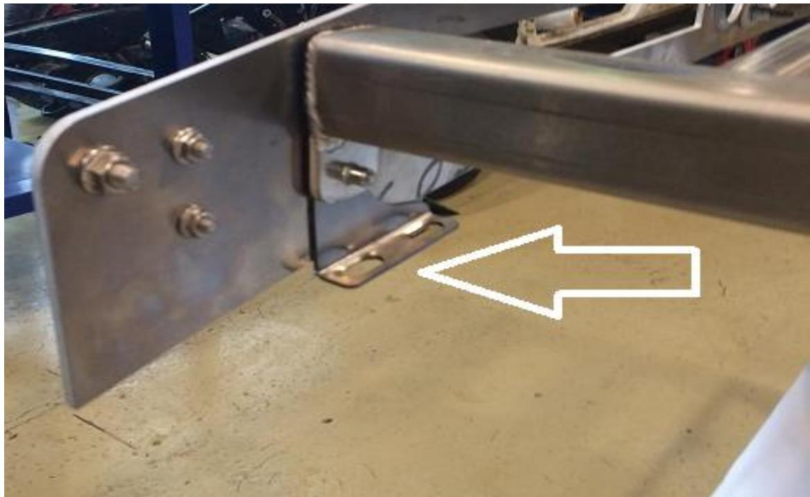
3. Переднюю часть таблички BMS прикручиваем комплектным крепежом, позиция 7,13
